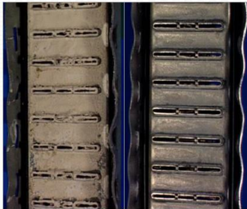
Коррозия и отложения в радиаторе (IAT-антифриз)
